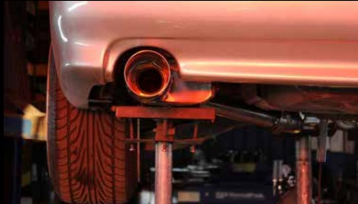
**15** Зеркально повторяем операцию, выравнивая левую и правую части при помощи пневматических подпорок. **ВНИМАНИЕ!** Важно соблюдать зазоры и сделать действительно геометрически правильный и красивый продукт. Помните правило: «Семь раз отмерь – один раз отрежь», тем более – полностью обвари.
