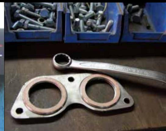
**4** Начинаем изготовление новой системы с монтажа фланца из нержавеющей стали толщиной 8 мм. Деталь изготовлена под заказ компанией «Механика» по образцу и подобию штатной.
